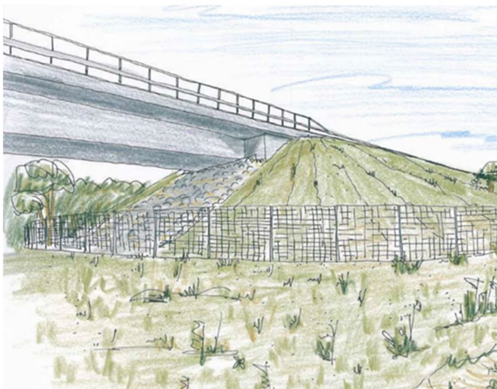
Figur 21 - Genomgående viltstängsel under bro (III.2.1:3 ur VV publ. 2006:47 (beskuren)).
