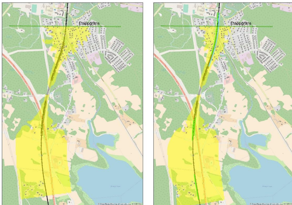
Figur 8.4-8. Alternativ Väst: Gräns för 70 dB(A) maximal ljudnivå 2 meter över mark, till vänster utan bullerskydd och till höger med bullerskydd. Bullerskyddsförslag är markerat med blått, oavsett bedömd höjd. Stödmur längs spår är markerad gul i figuren.
