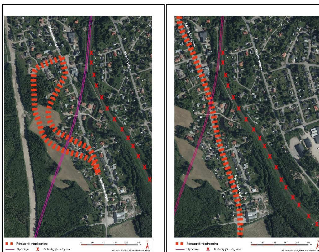
Figur 8.5-1. Väg 562 (Njurundavägen) dras om väster om befintliga Njurundavägen. Figur 8.5-2 Väg 562 byggs om i befintlig sträcka.
