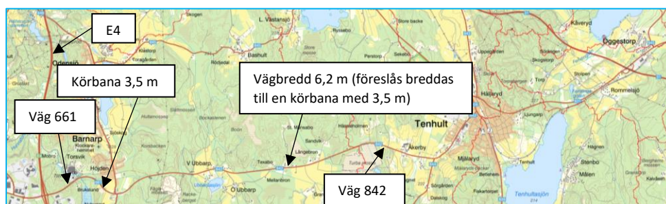
Figur 4. Vägbredder befintlig väg 661 och väg 842.
