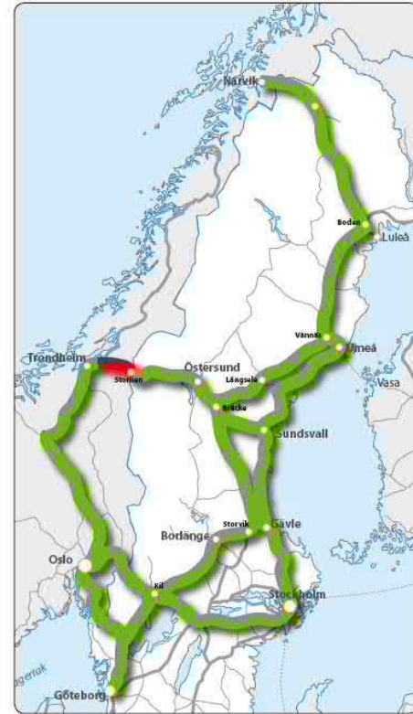
Meråkerbanan, delen mellan Hell och Storlien är inte elektrifierad, vilket begränsar möjligheterna för effektiva tågupplägg.
