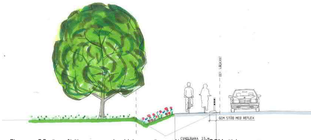
Figur 11. GC-vägen förläggs som en breddning av väg 934 åtskiljd med GCM-stöd.
