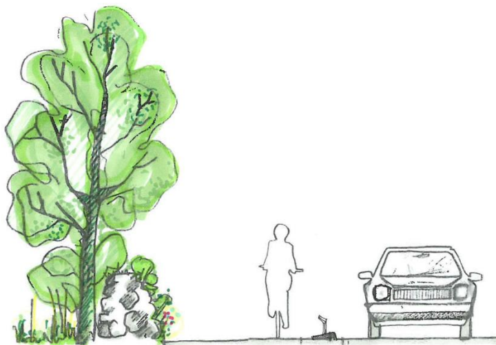
Figur 10 Trång sektion utformad med gång-, cykel- och mopedstöd (GCM-stöd) som avskiljning.
