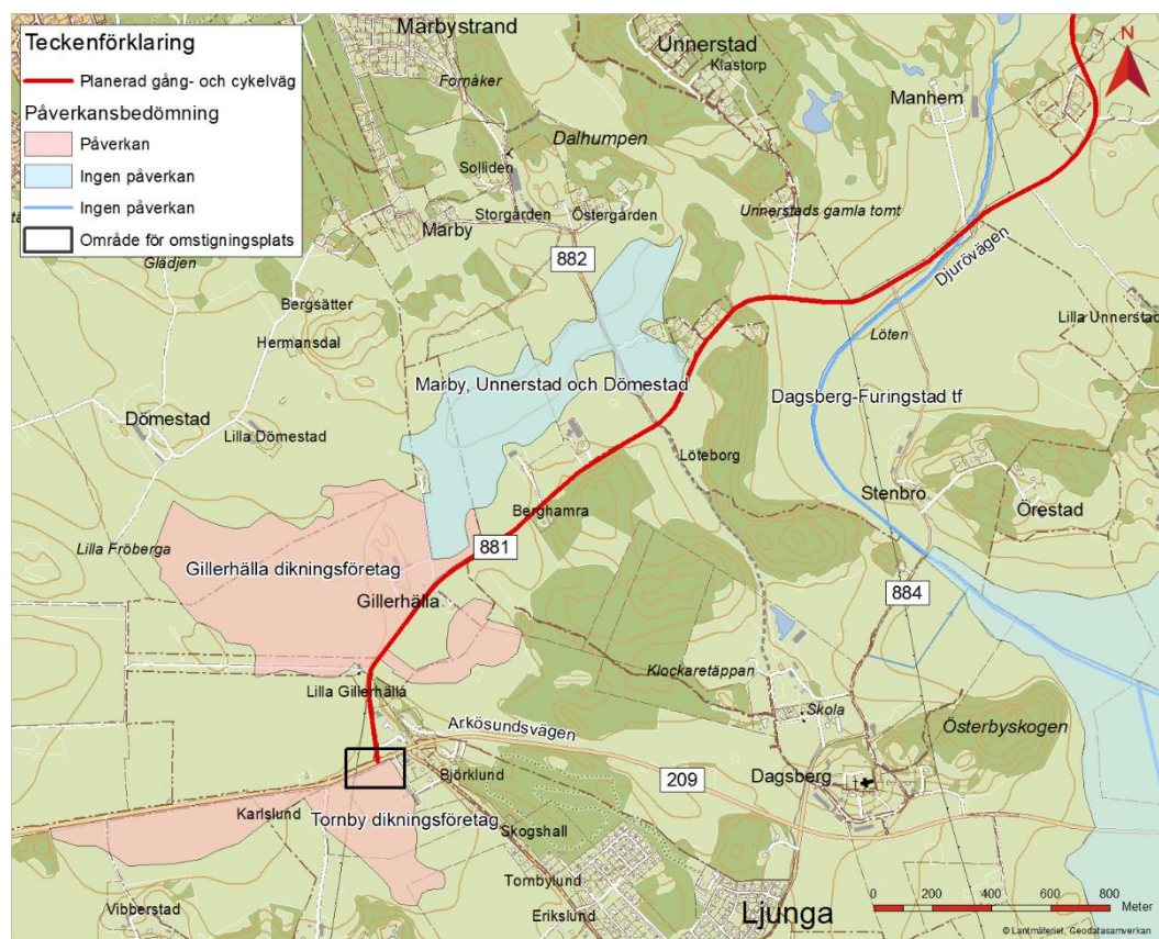
Figur 35. Karta över markavvattningsföretag längs sträckan Arkösundsvägen – Stora Sidus.
