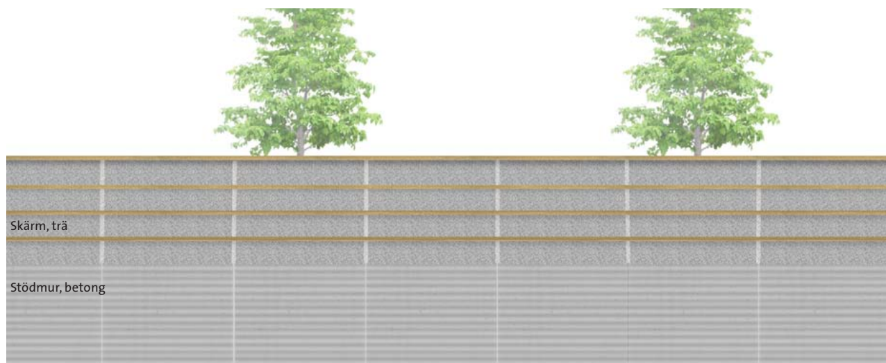
Figur 23. Elevation bullerskärm mot spåren Skala 1:100
