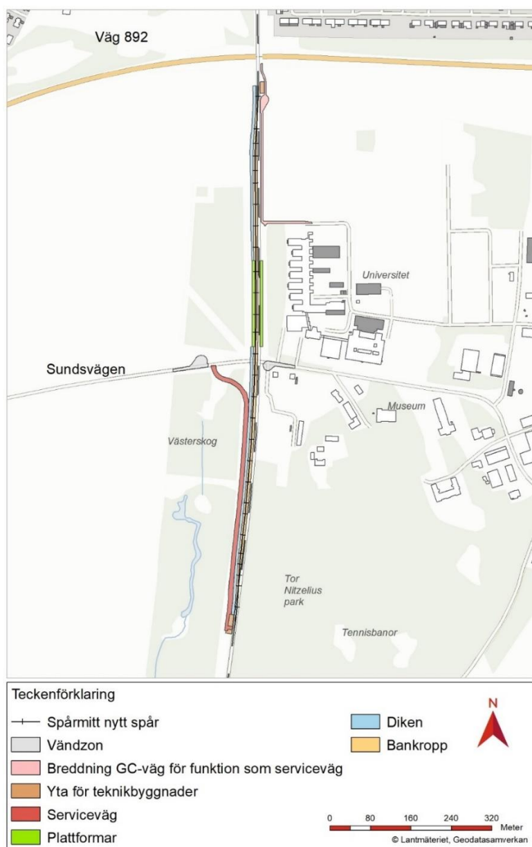
Figur 13. Placering av plattformar, teknikbyggnader och mötesspår (Sweco).
