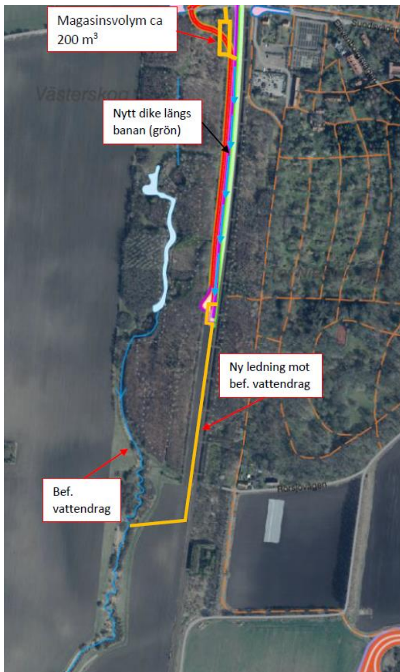
Figur 15. Befintliga dräneringssystem och principiella lösningar för dagvattenhanteringen i Alnarp (Sweco).
