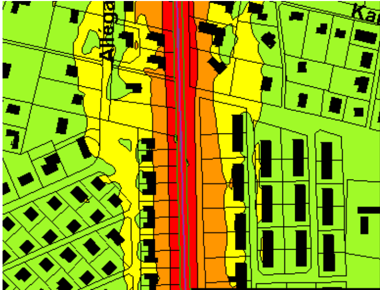
▲ Figur 3. Ekvivalent bullerutbredning på två meters höjd i utbyggnadsalternativet, med en 2 meter hög bullerskärm. Färgskalan representerar 5 dB(A) intervall. Röd färg visar gränsen för 60 dB(A).
