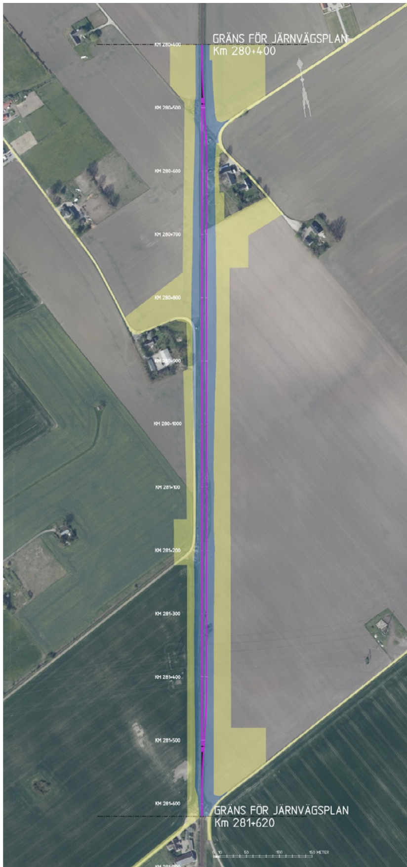
Figur 5.7:1 Lila linjer markerar järnvägsspåren. Gula linjer markerar planerade byggvägar och gul skrafferad yta markerar tillfällig nyttjanderätt för upplag och etableringsytor mm under byggtiden. Blått område markerar produktionsområde.
