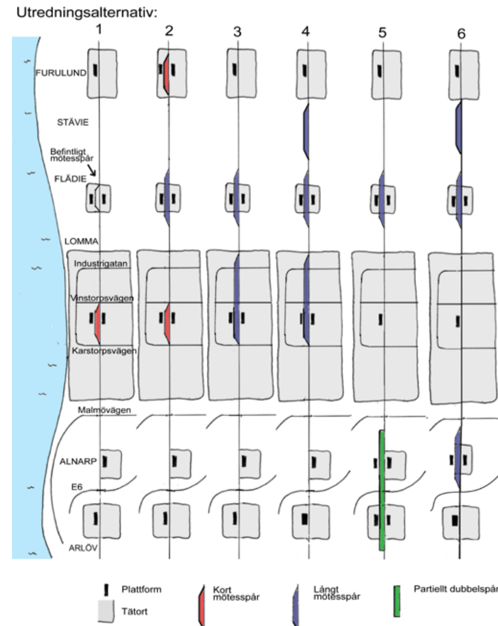
▲ Figur 2-1. Principskiss över de olika utredningsalternativen. Observera att de inbördes proportionerna av spårlängden är schematiskt angiven.
