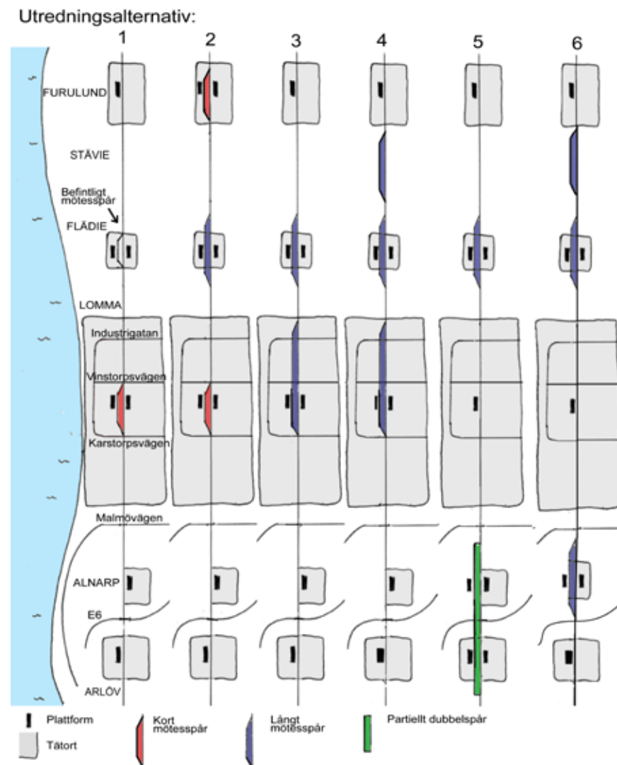
▲Principskiss över de olika utredningsalternativen.
