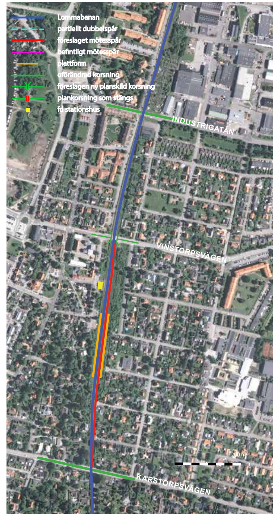
▲ Figur 9-5. Schematisk redovisning av alternativet kort mötesspår i Lomma.
