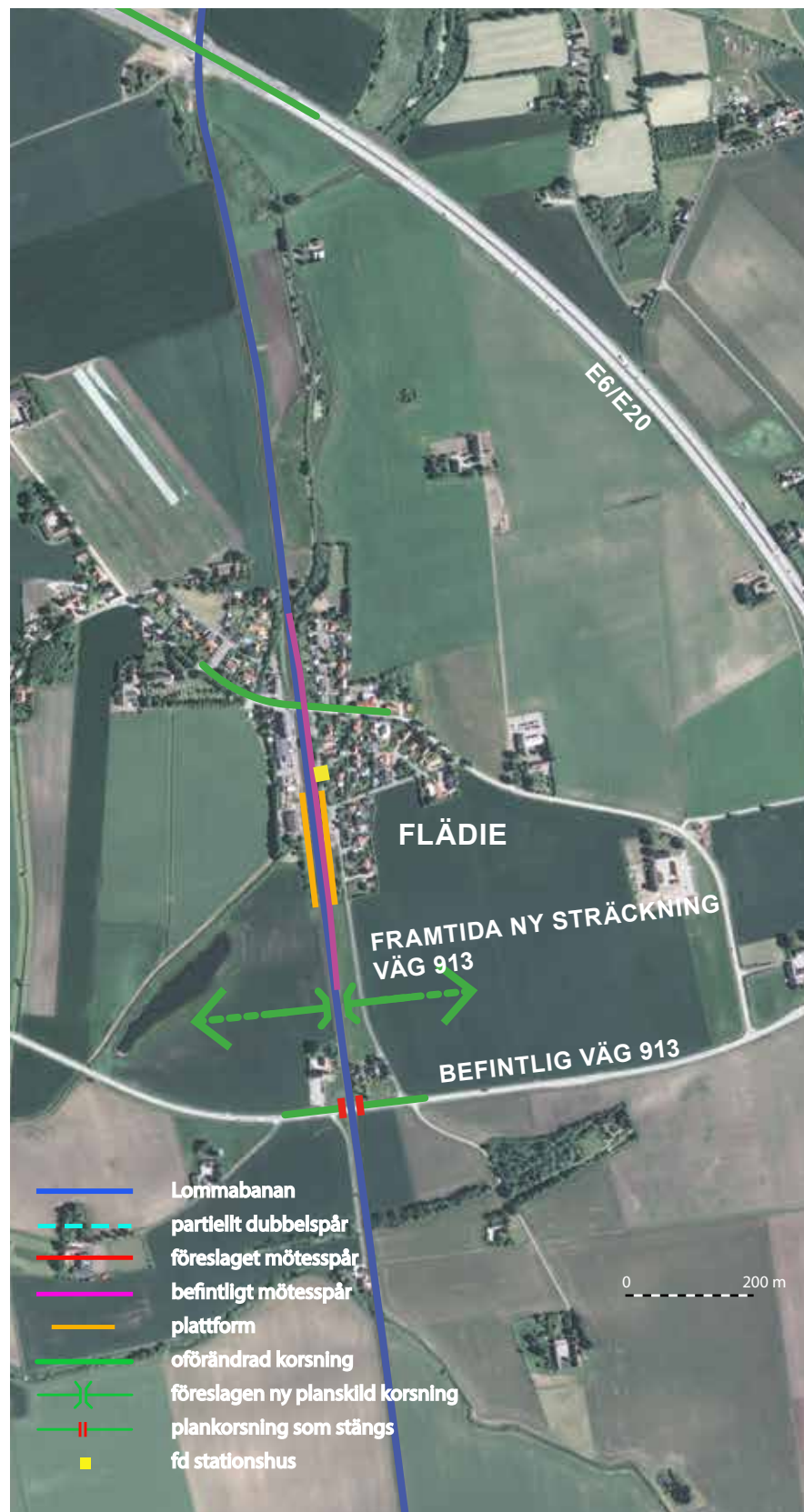
▲Figur 9-9. Flädie - befintligt kort mötesspår, föreslagen placering.
