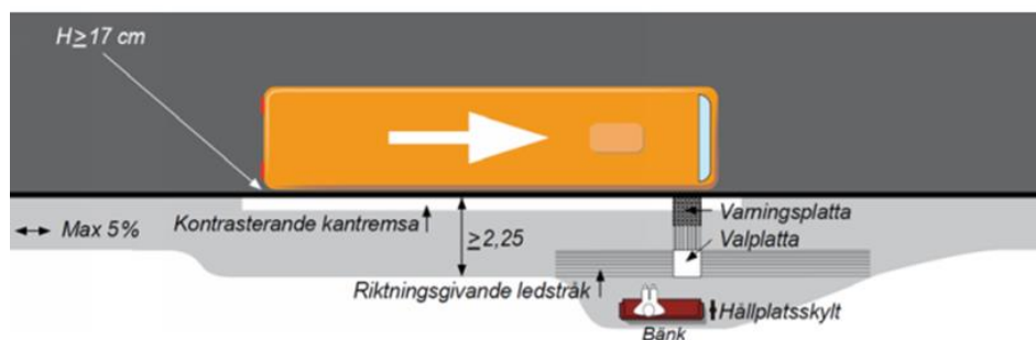
Figur 27. Utformning av plattform för busshållplats typ 2. (Figur från Vägars och gators utformning)
