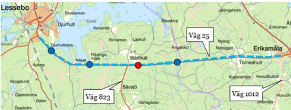
Översiktskarta Lessebo-Eriksmåla med planerade åtgärder. Röd prick anger läget för faunapassage i plan, blå prickar anger läget för planskilda faunapassager för små och medelstora djur. Ljusblå streckad linje anger sträckan där faunastängsel planeras att byggas.
