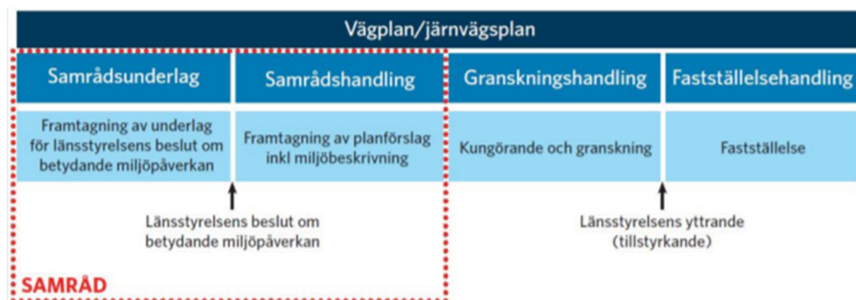
Figur 4. Trafikverkets planläggningsprocess för vägplan.
