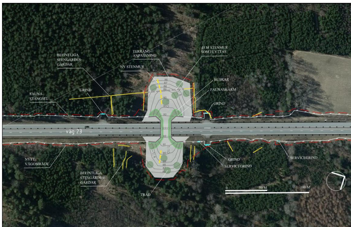
Figur 6. Plan som visar faunabrons utbredning vid passage 2.
