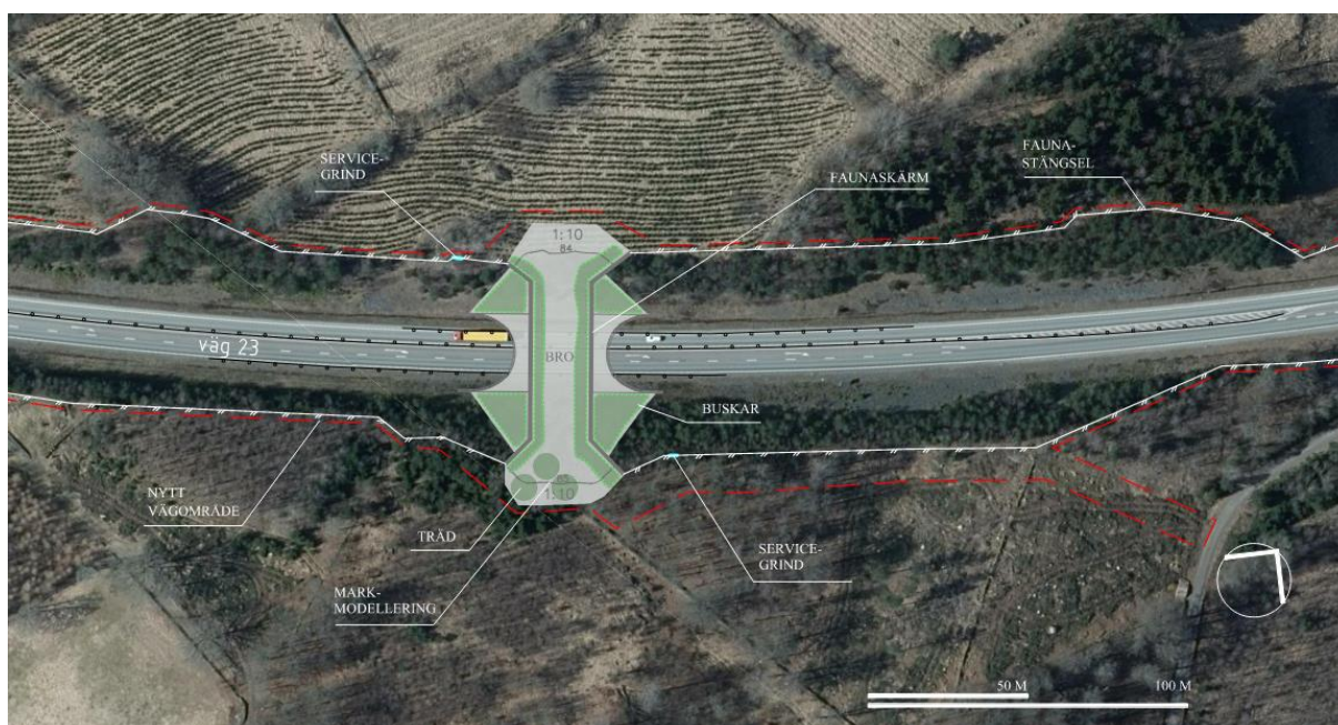
Figur 10. Plan som visar faunabrons utbredning vid passage 5. Brotypen i figuren är en stålvalvsbro.
