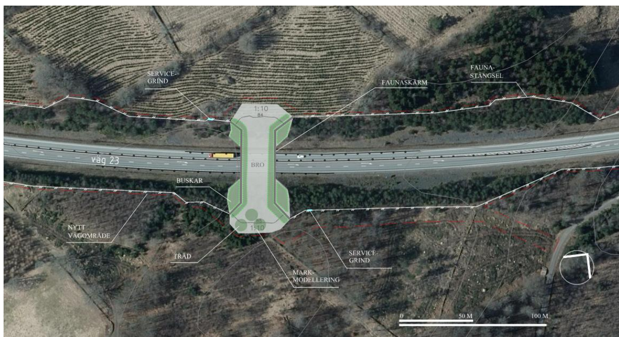
Figur 12. Plan som visar faunabrons utbredning vid passage 5. Brotypen i figuren är en plattrambro.
