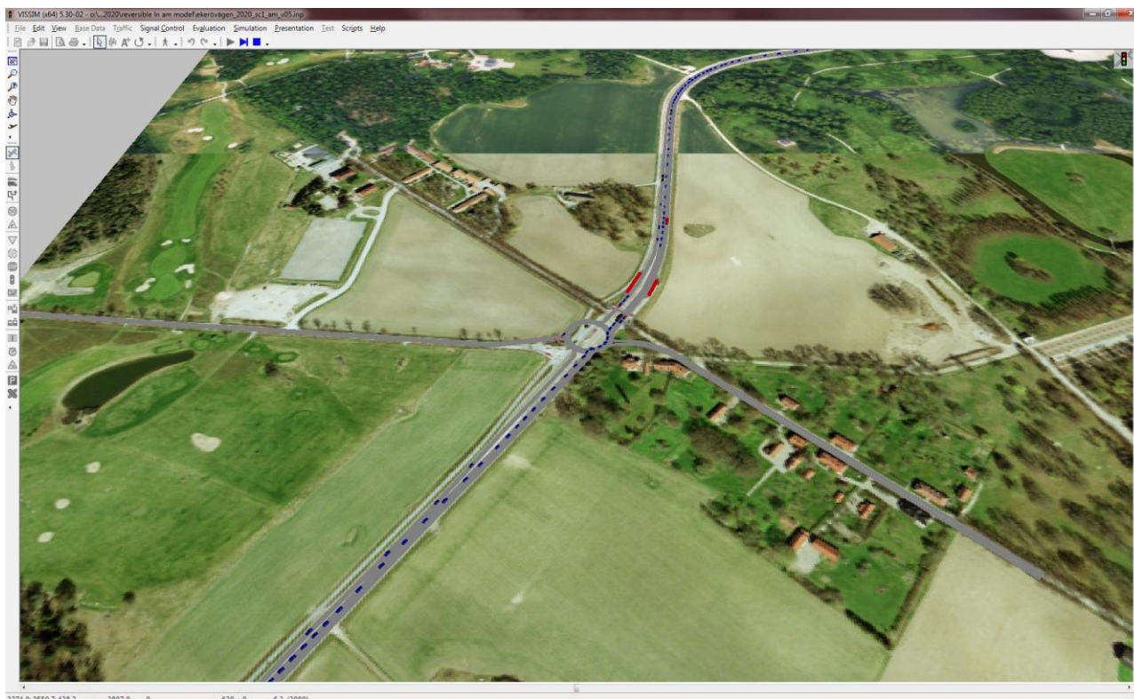
Figur 9 Hög belastning i södra tillfarten i korsningen vi Kanton under förmiddagens maxtimme år 2020.
