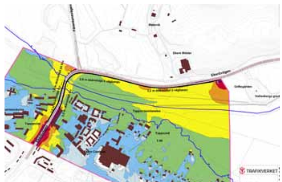
Figur 5.40 Bulleberäkning vid Tappström och på delar av Lindö för utbyggnadsförslaget, med framtida hastighet 80 km/h på Lindö och bullerskärmar utmed Ekerövägen.
