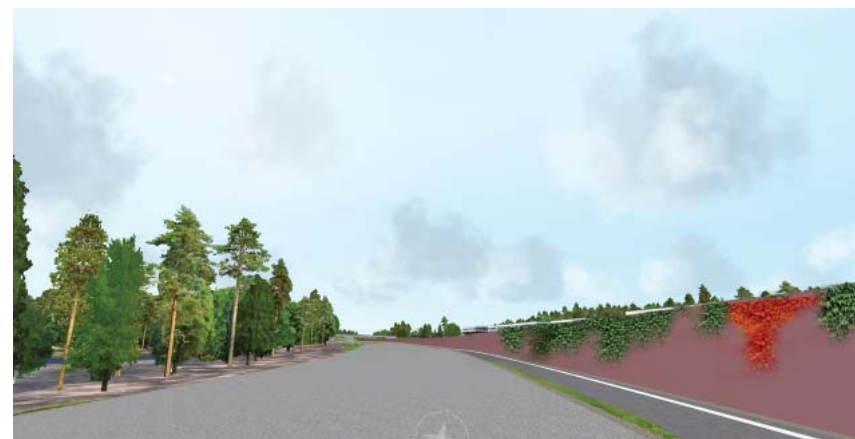
Figur 31. Gröna partier med klätterväxter, kan även vara ett sätt att binda samman den östra sidan av vägen med bullerskärmen.
