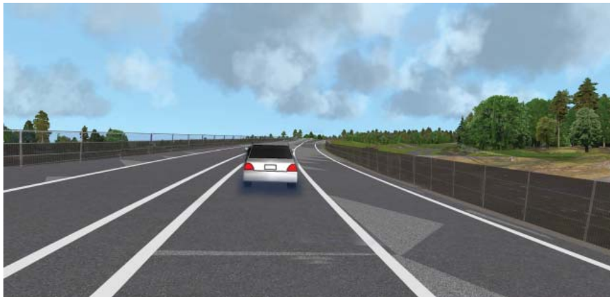
Figur 81. Transparent skärm medför utblickar över landskapet och underlättar för orienterbarhet.
