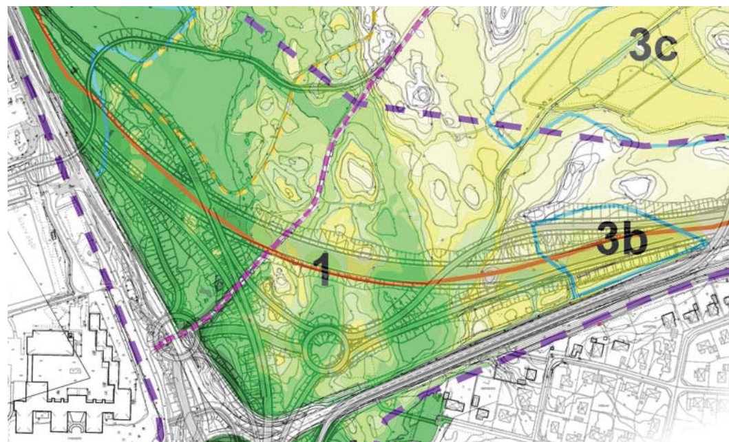
Figur 52. Kartöverslag som visar hur de nya vägarna och cirkulationsplatsen i öster förhåller sig till befintlig terräng.
