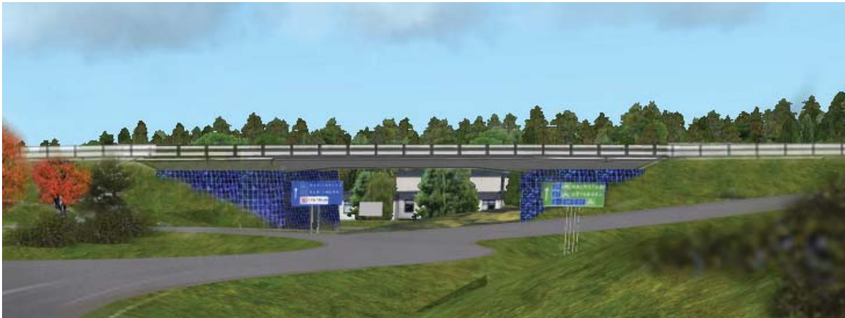
Figur 65. Fotomontage över princip för glasgabion i dagsljus.
