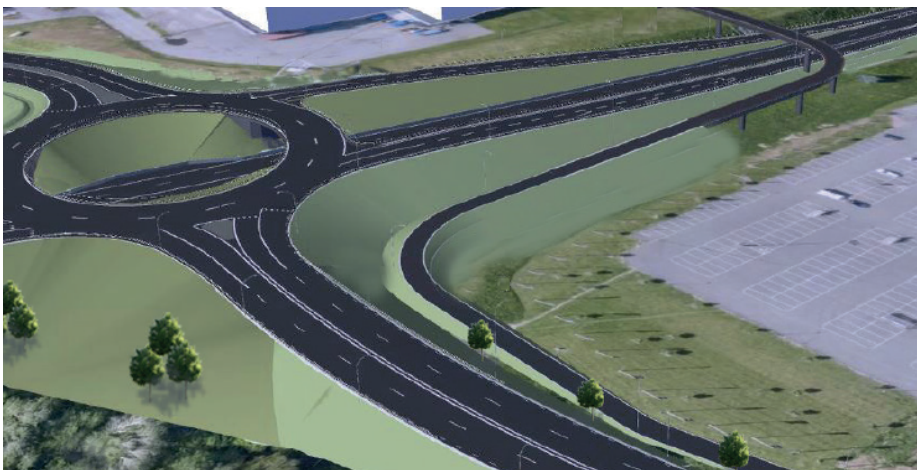
Bild 12. Nordöst om cirkulationen görs slänten utmed gång- och slänten med lutning 1:4. Sandytor som kompensering för de livsmiljöer för insekter som tas bort placeras i vägs slänten.
