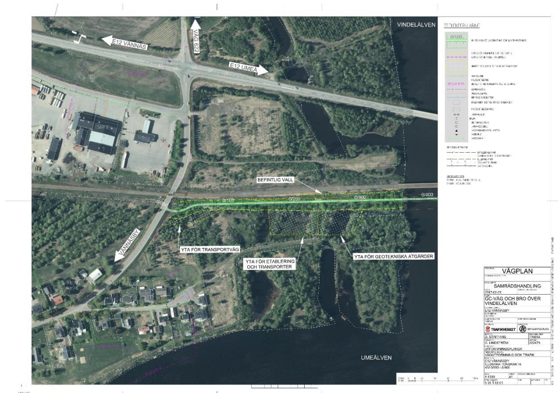
Figur 3.8.6. Fyllning kommer att ske i mindre vattenområden markerade som ”Yta för etablering och transporter” och ”Yta för geotekniska åtgärder” på kartan.
