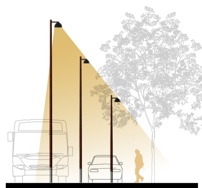
BELYSNING TRAFIKYTOR - undvika bländning och skapa överblick för ökad trygghet. Varierande höjd på stolpar utifrån trafikmiljö och rumslig skala
