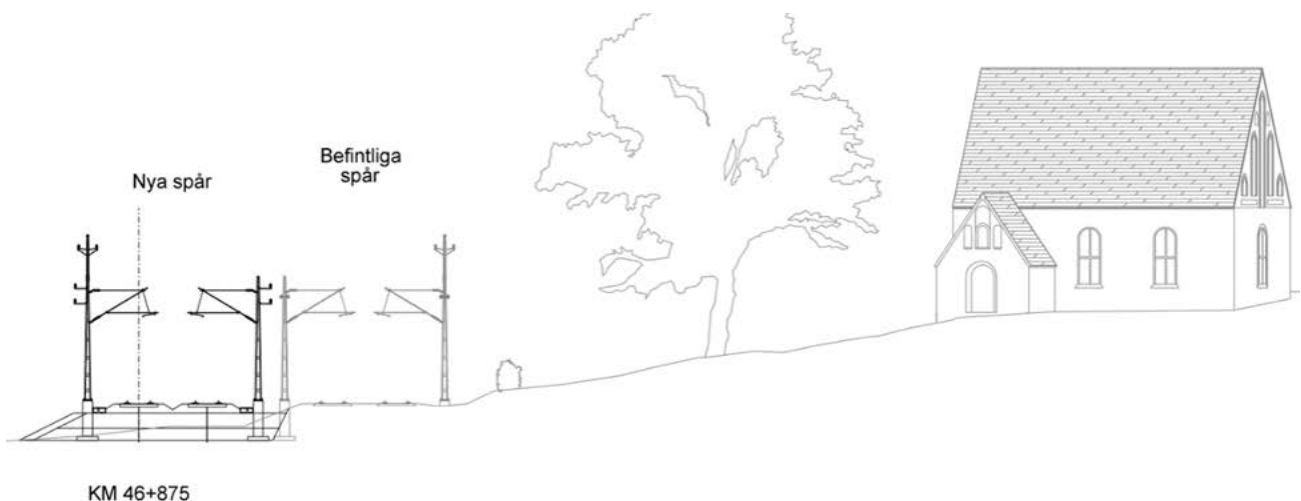
Figur 73. Sektion vid S:t Stefans kyrka, samt princip för utbyggnad väster om befintliga spår.
