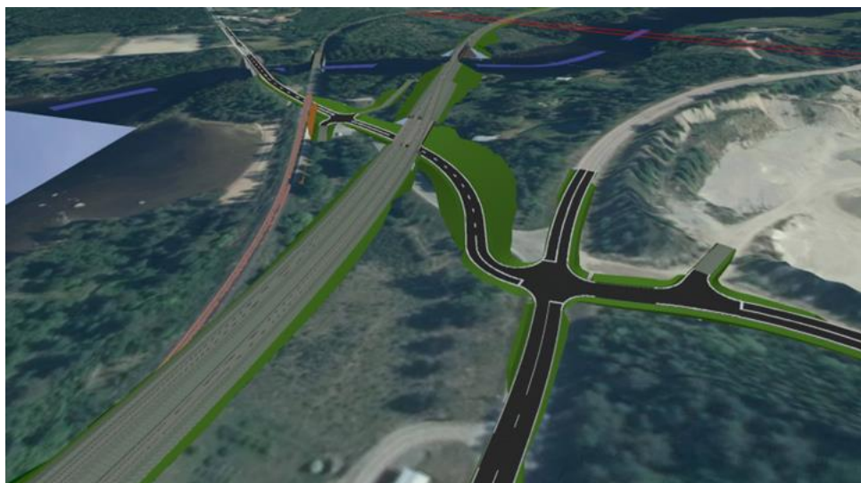
Figur 16. Tidig principskiss för bortvalt utformningsalternativ med hög spårlinjeprofil och järnvägen på bro över väg 516.
