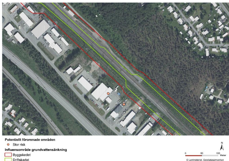
Figur 5.1-3. Beräknad grundvattensänkning under bygg- respektive driftskede med fastigheter med nedlagda kemtvättar, objekt i riskklass 2 (stor risk).
