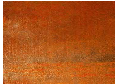
Figur 108. Referensbild - Corten (rostrogt stål)
