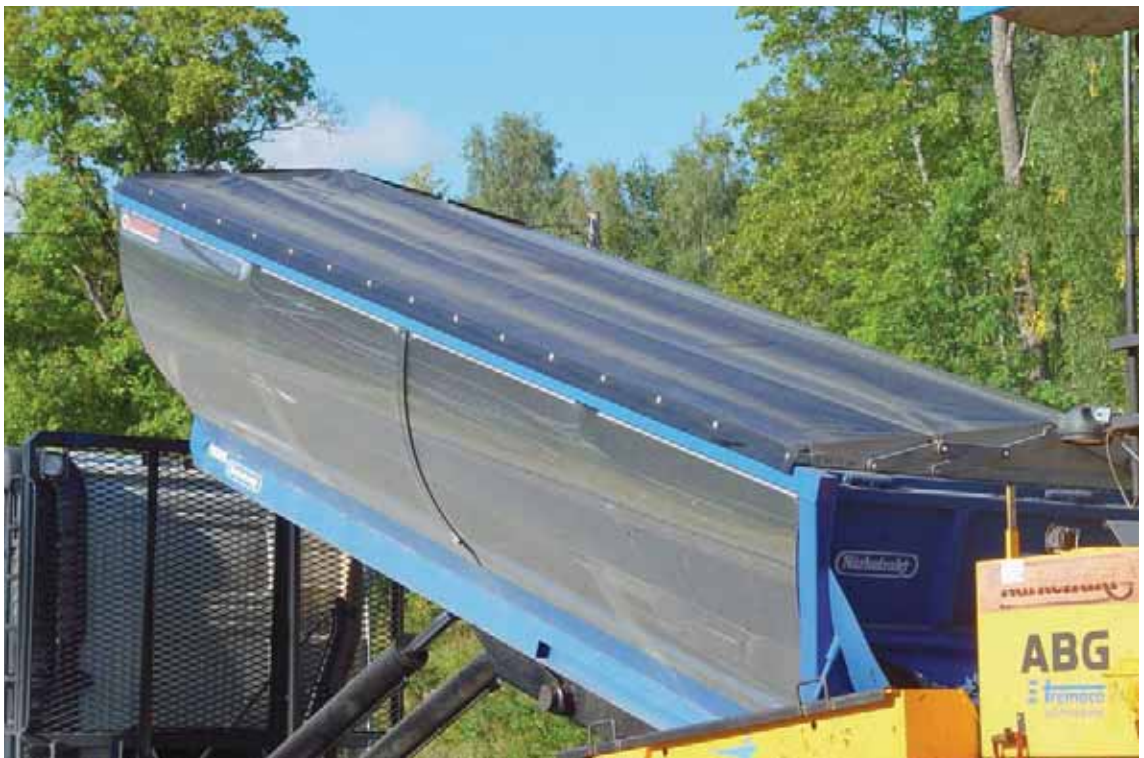
Rätt! Ännu bättre är rundbottnat trailerflak med god täckning.
