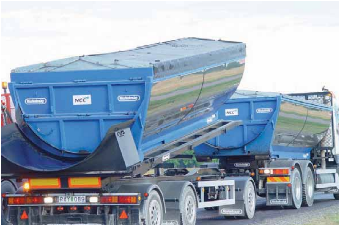
Rätt! Bra isolerade runda flak på bil och vagn.
