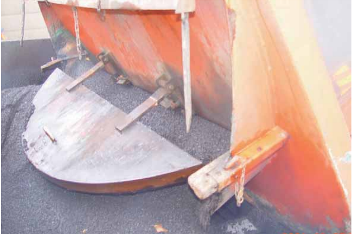
Rätt! Bra isolerad bakstam på en rundbottenad bil.
