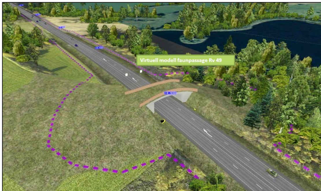
Figur 45. En virtuell modell av faunapassage väg 49. I ett flackt landskap behövs en terrängmodellering för att anslutningarna till brons mynningar skall bli så bra som möjligt.
