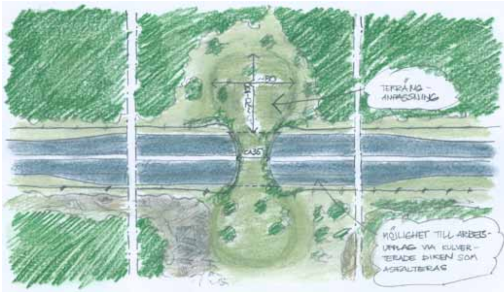
Figur 6:7 Principfigur för utbredningen av kringområdet kring en ekodukt.
