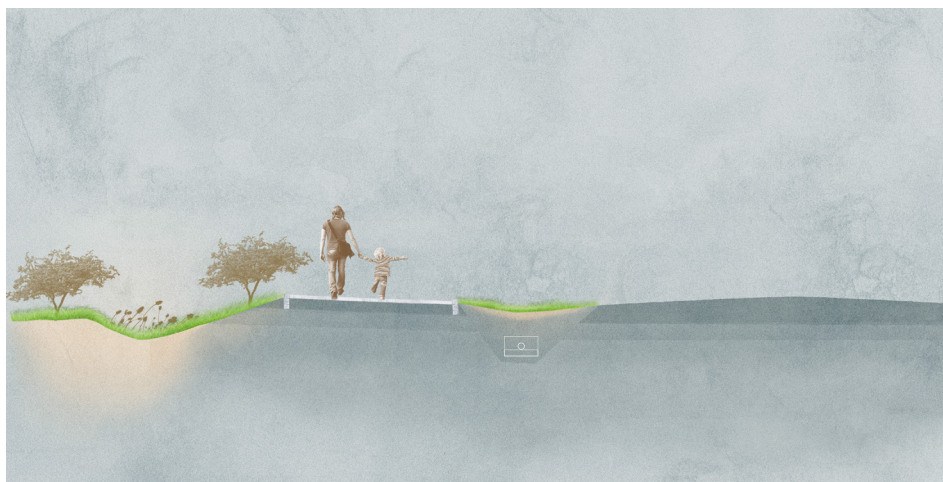
Figur 5.2 Utformningen av gång- och cykelvägen kommer för större delen av sträckan att utformas frilliggande från väg 345. Ett gräsbevuxet dike skiljer vägarna åt.
