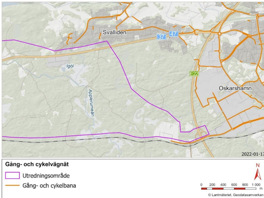
Figur 7 - Gång- och cykelvägnätet i närområdet markerade med orange (NVDB, Nationell vägdatabas)
