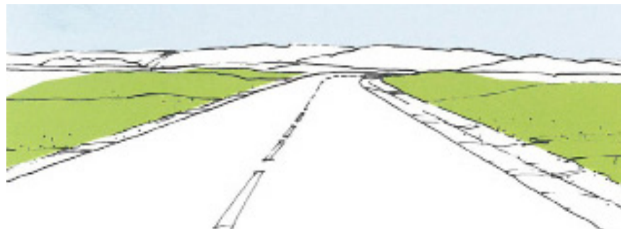
Figur 8. Med ett bredare vägområde kan slänterna göras brukbara längre in mot vägen. Bra för markägaren och landskapsbilden. Källa bilder: Vägen, en bok om vägarkitektur av Benny Birgersson.
