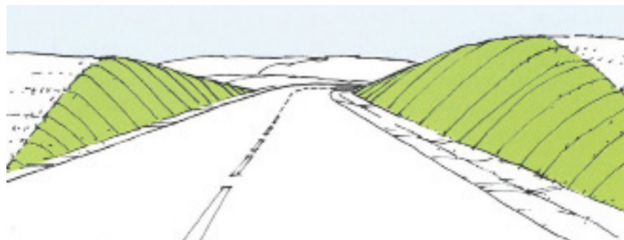
Figur 7. Avrundad slänt. Ett alternativ till propellerbladslänt där platsutrymmet är begränsat.
