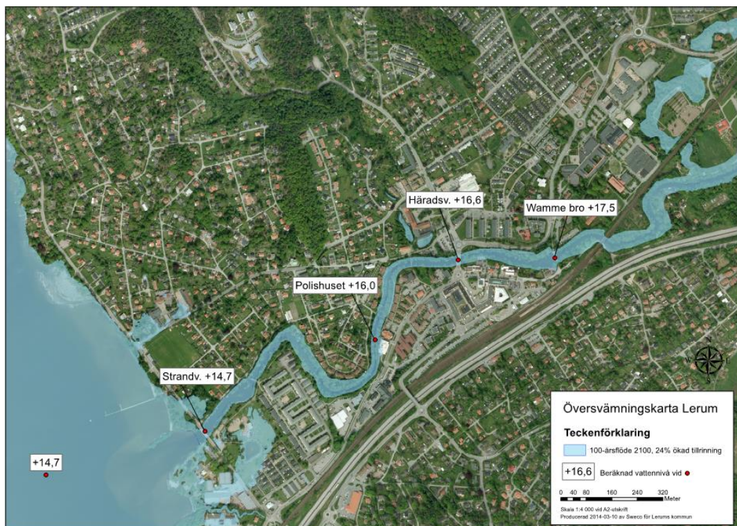
Figur 2: Översvämningskarta Lerum. Visar beräknade nivåer i sjön Aspen och Sävån år 2100 vid HQ100 med klimatkompensation [Sweco, 2014-03-28].
