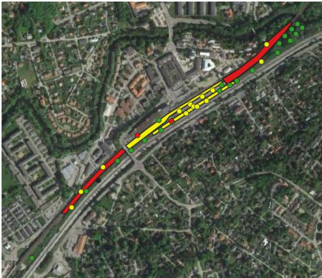
Figur 27 Sammanställning av genomförd markmiljöprovtagning vid Lerum station. Punkt markerar undersökningspunkt för genomförd provgrovsgrävning eller skruvprovtagning. Färgat område avser delområde för genomförd ytlig samlingsprovtagning. Grön färg avser påvisad föroreningshalt under MKM, gul färg avser påvisad föroreningshalt mellan MKM och MKM, röd färg avser påvisad föroreningshalt över MKM. Vid svart prick saknas laboratorieanalyser (XRF-analys finns). Kartunderlag från Google.
