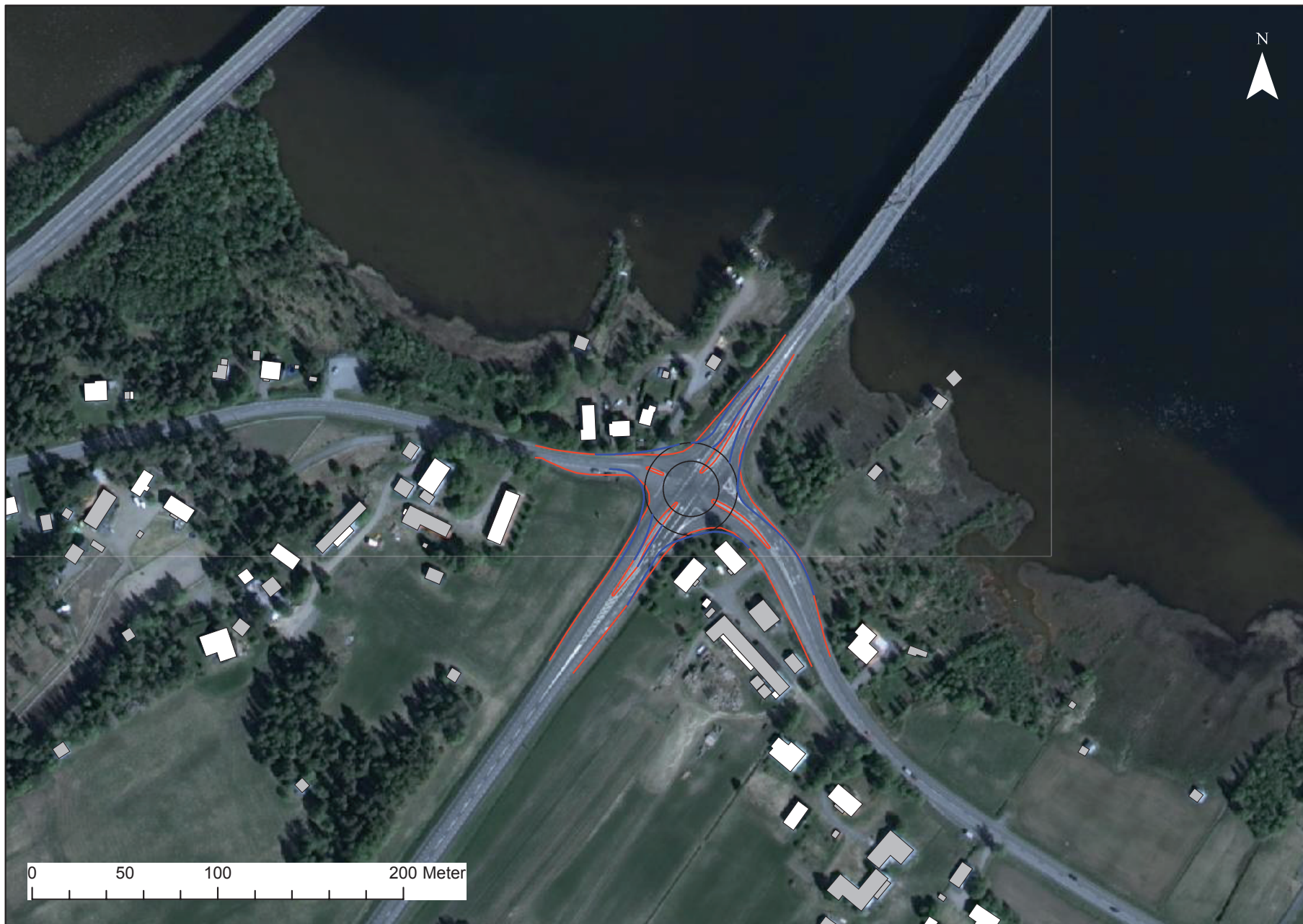
Bild 5.3 Exempel på möjlig utformning av cirkulationsplats
