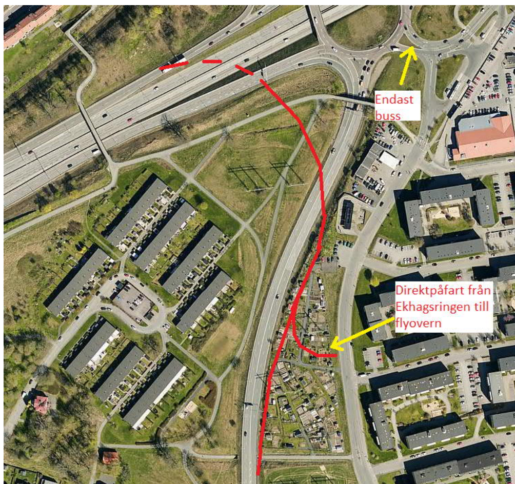
Figur 4: Grov skiss över lösningsförslaget med direktpåfart från Ekhagsringen till flyovern samt stängning för biltrafik ut från Ekhagsringen till cirkulationsplatsen mot E4S/Odengatan (fortsatt tillåtet mot E4N samt rakt fram mot lokalområdena).
