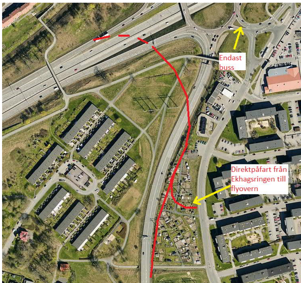
Figur 15: Grov skiss över lösningsförslaget med direktpåfart från Ekhagsringen till flyovern (åtgärd 3B) samt stängning för biltrafik ut från Ekhagsringen till cirkulationsplatsen för vidare färd mot E4S/Odengatan (ingår i åtgärd 3D). Istället tillåts enbart bussar i denna relation. För mer detaljer hänvisas till PDF-skissen, där samtliga föreslagna åtgärder visas.
