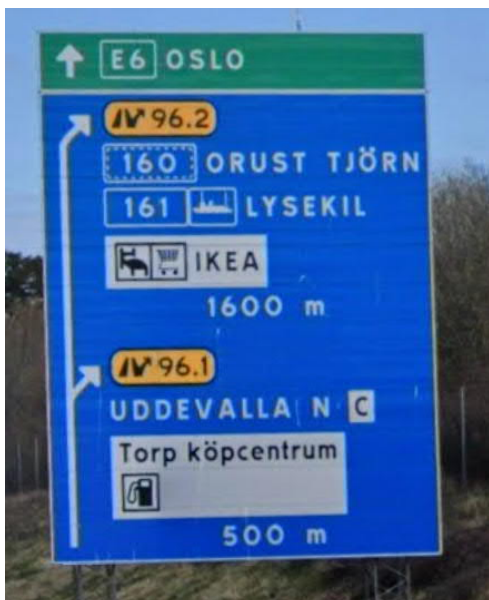
Figur 40: Möjlig skyltning söder om Tpl Huskvarna Södra i norrgående riktning. Exemplet är hämtat från E6 Uddevalla (hastighetsgräns 110 km/h, dvs. högre än på E4 vid denna plats) och avstånden mellan trafikplatserna skulle bli ungefär desamma.
