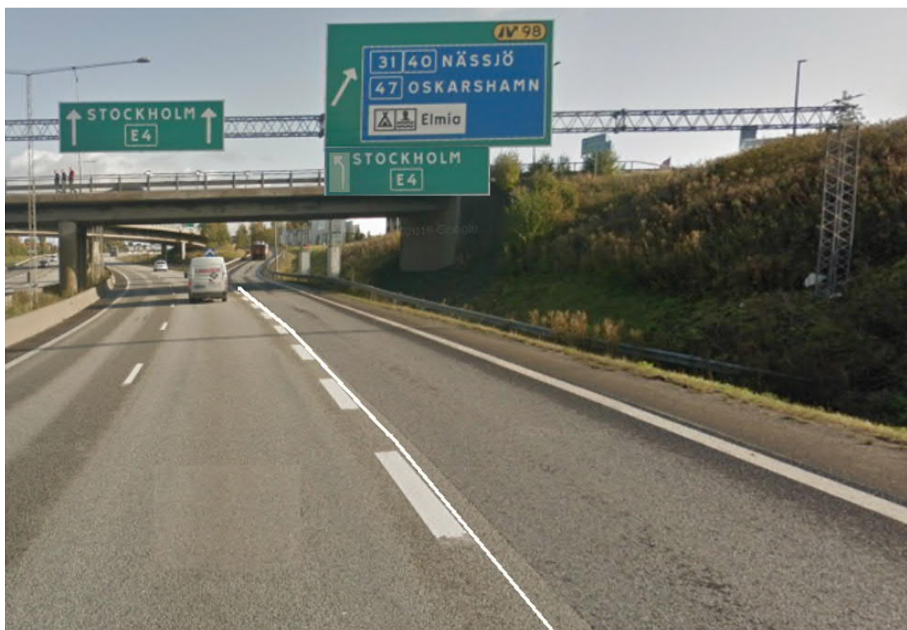
Figur 5: Enkelt fotomontage över linjemålning och skyltning på dagens additionssträcka. På denna sträcka enbart tillåtet för fordon från K1 till K0 att genomföra körfältsbyte, likt målningen på dagens E4 i södergående riktning mellan Tpl Ekhagen och Odengatans avfart. Genom att E4 Stockholm skyltas även i det högra körfältet förstår bilisterna att de kan ligga kvar i detta körfält. När avfarten längre fram har vikit av kommer ny skyltning att ta vid som upplyser trafikanterna om att det högra fältet upphör som en parallellpåfart.
