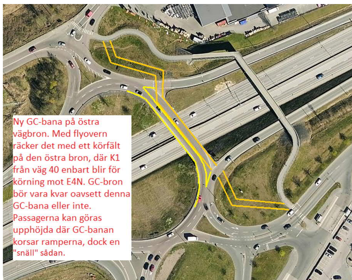
Figur 25: För att öka den upplevda tryggheten att korsa E4 under kvälls/nattetid föreslås att höger bilfält på den östra vägbron görs om till GC-bana (åtgärd 3E). Det finns även ett symbolvärde i att på detta sätt göra om ett bilfält till GC-bana. Körfältsindelningen in mot cirkulationen på väg 40 i nedförsbacken får då göras om så att K1 enbart blir för körning mot E4 norr.
