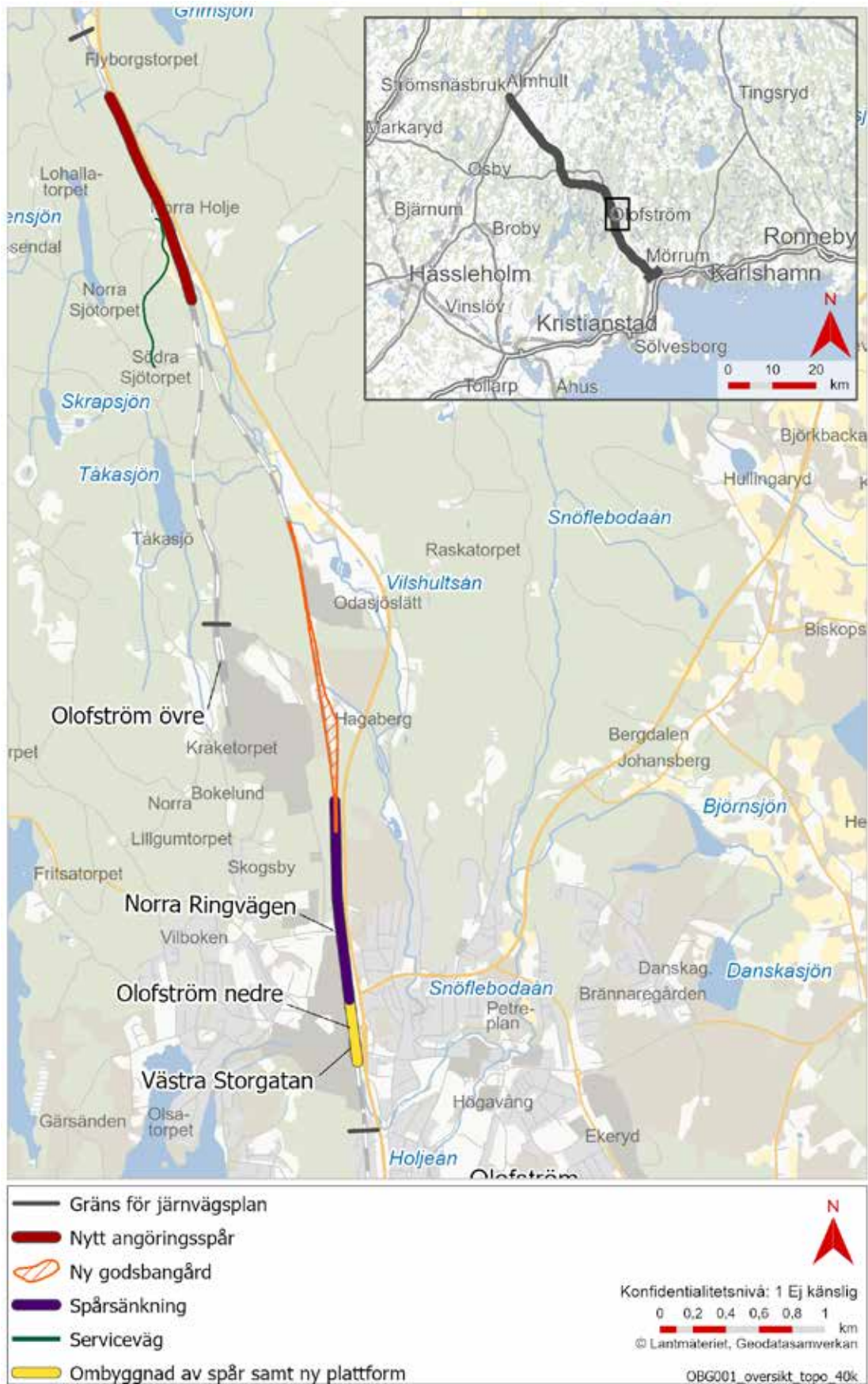
Figur 1.1 Översikt över ingående delar i projekt Olofströms bangård. Hela Trafikverkets anläggning ska elektrifieras och Olofström nedre ska anpassas till de nya anläggningsdelarna. Den inklippta rutan i övre högra hörnet visar Sydostlänkens sträckning i svart och projektets placering markerad med en ruta.
