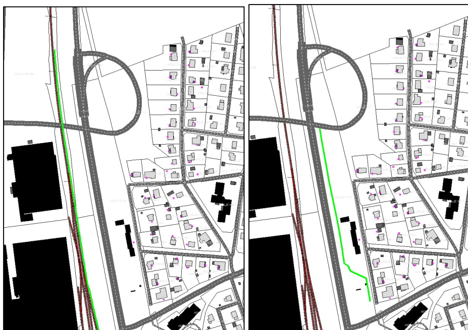
Figur 16. Placering av utredda skärmalternativ. Grön markering är skärm. Till vänster: Spårnära skärm 3,5 meter från spårmit. Till höger: Skärm mellan byggnader och väg.
