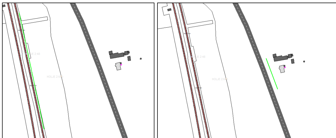
Figur 9. Placering av utredda bullerskydd. Till vänster: spårnära skärm 3,5 meter från spårmitt. Till höger: vägnära skärm, 5 meter från vägkant.
