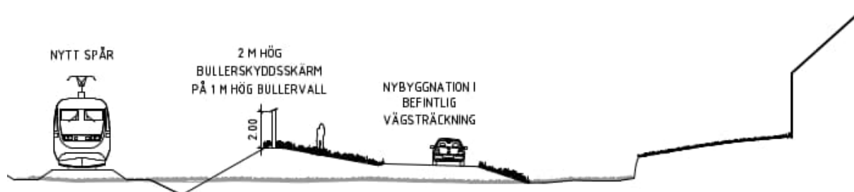
Figur 3. Principskiss över bullerskydd vid km 37+200 till 37+350 (HOLJE 2:643 och 2:593). Totalt 3 meter högt bullerskydd bestående av 1 meter hög vall och 2 meter hög skärm.
