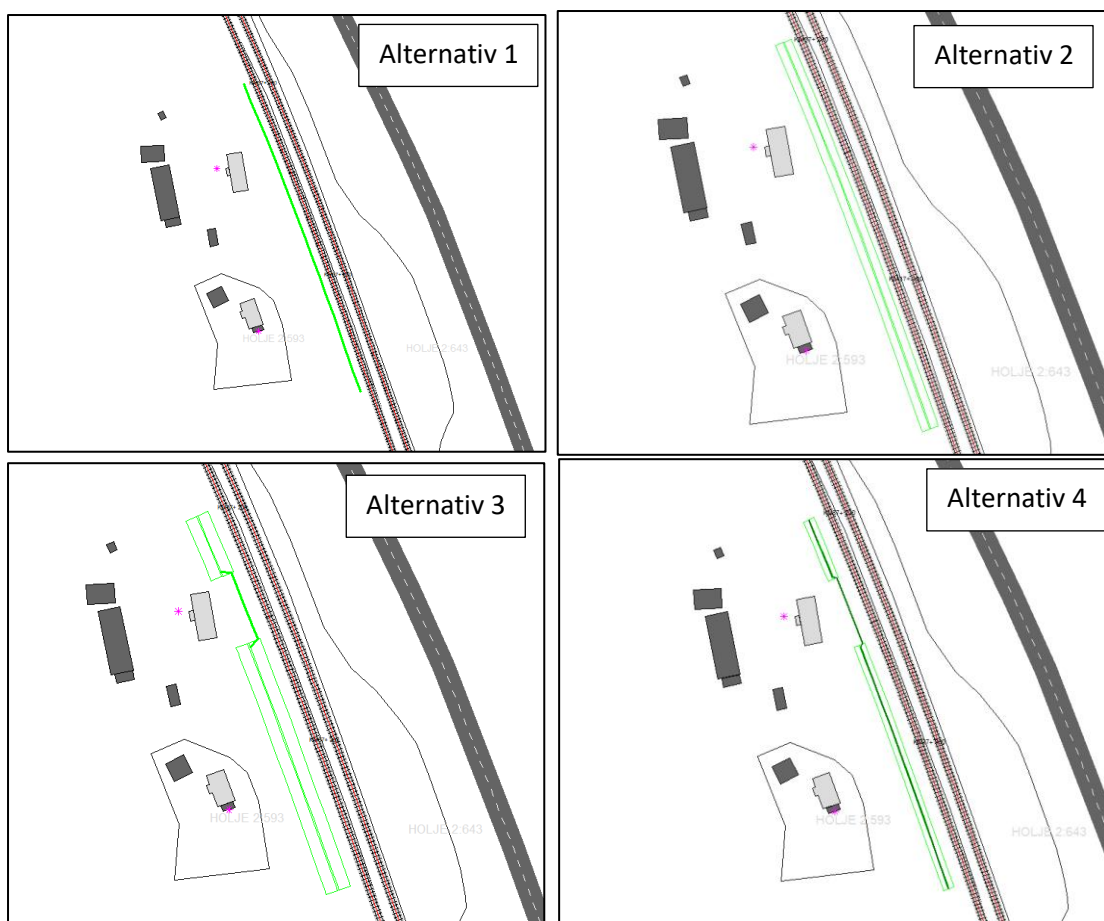
Figur 7. Placering av utredda bullerskydd. Alternativ 1: skärm 5,2 meter från närmaste spårmit. Alternativ 2: vall 1:1 lutning samt vall+skärm 1:2 lutning, start 3,5 meter från närmaste spårmit. Alternativ 3: Vall 1:1,5 lutning med skärm förbi HOLJE 2:643. Alternativ 4: vall med skärm ovanpå samt enbart skärm förbi HOLJE 2:643.
