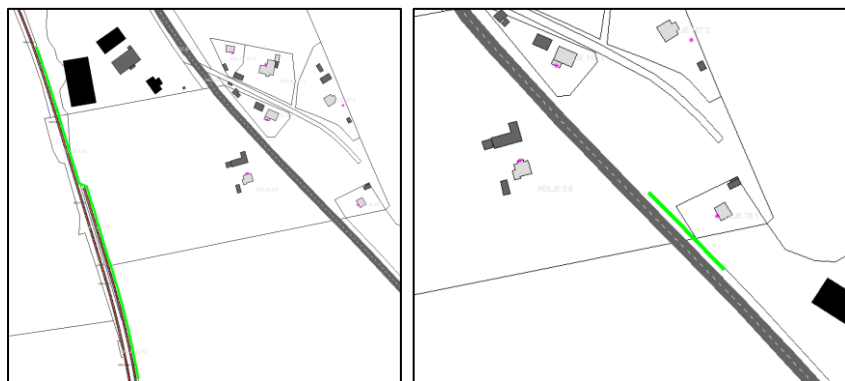
Figur 14. Placering av utredda bullerskyddsskärmar. Grön markering är skärm.
