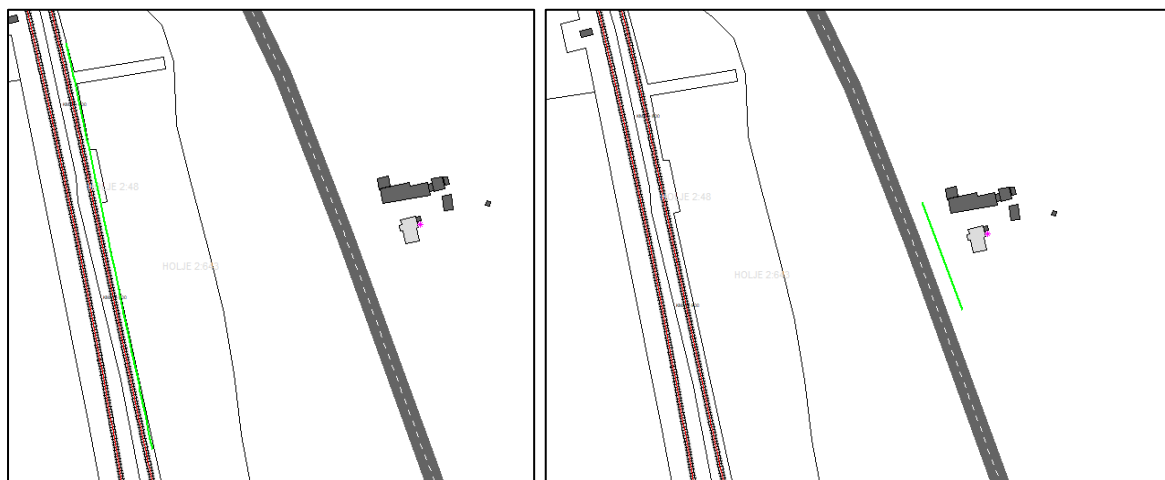
Figur 9. Placering av utredda bullerskydd. Till vänster: spårnära skärm 3,5 meter från spårmitte. Till höger: vägnära skärm, 5 meter från vägkant.
