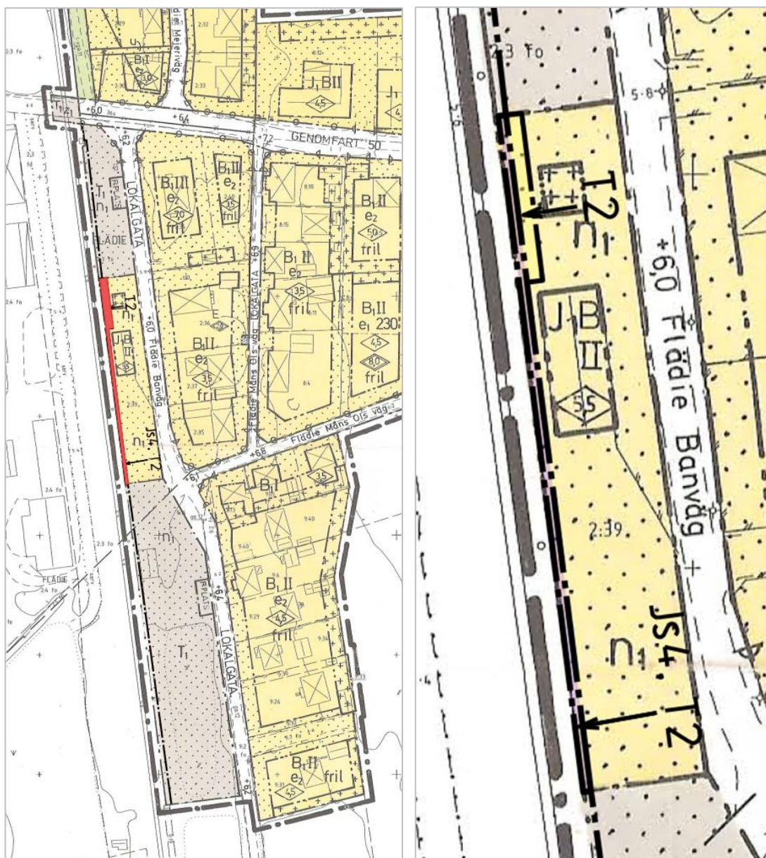
Figur 17. Utdrag ur berörd detaljplan Detaljplan för östra delen av Flädie by (Fjellie 8:8 m fl), 1989 med berörda delar markerat i rött (vänster). Redovisning av markanspråk från järnvägsplanen: ny järnvägsmark med servitutsrätt (Js4) och markanspråk för tillfällig nyttjanderätt (T2) (höger).
