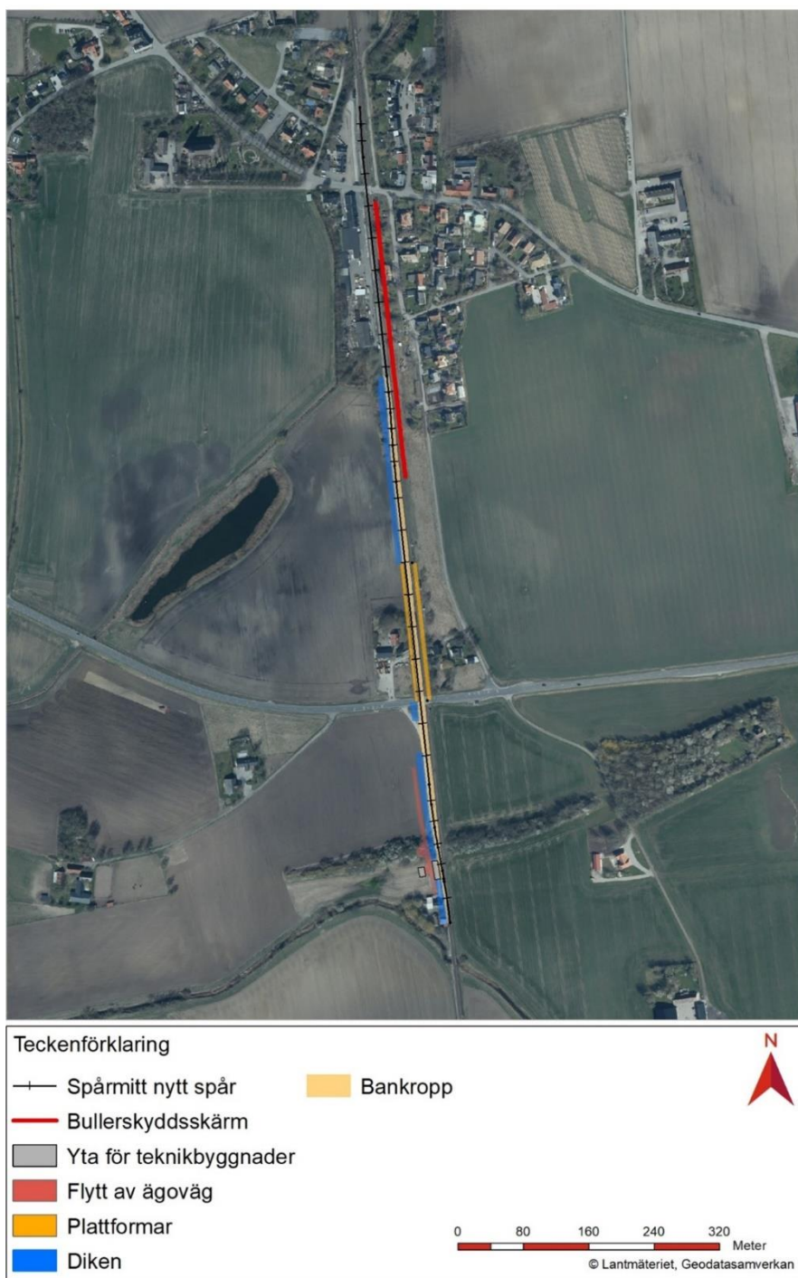
Figur 12. Placering av plattformar, teknikbyggnader och mötesspår (Sweco).
