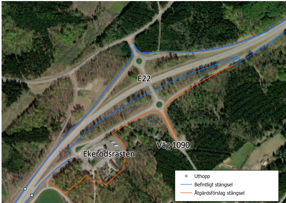
Figur 32. Första alternativet på föreslagen dragnig av faunastängsel runt trafikplats Ekeröd samt avslut av faunastängsel och placering av uthopp.
