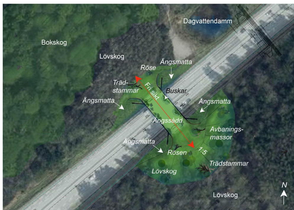
Figur 35. Principskiss över faunabrons gestaltning.
