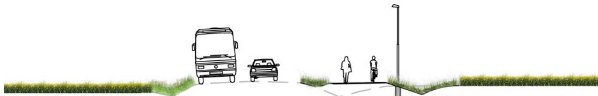
Figur 16. Typsektion illustrerar normalsektion av GC-vägens utseende och läge gentemot väg 537 över åkermark.
