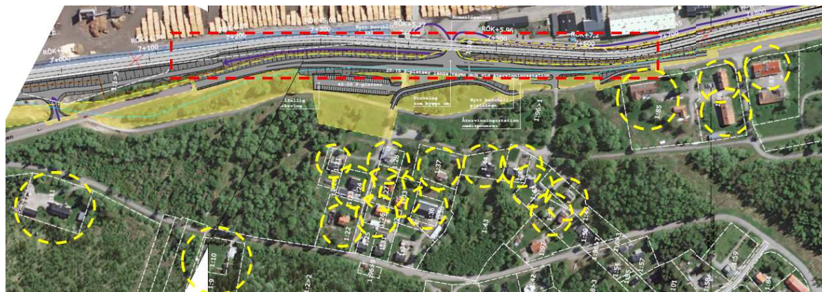
Figur 2. Ombyggd väg i anslutning till infarten till Tunadals sågverk är markerad med röd rektangel. Bostadsbyggnader som beräknas få ett bullertillskott från ombyggd väg är markerade med gula cirklar.
