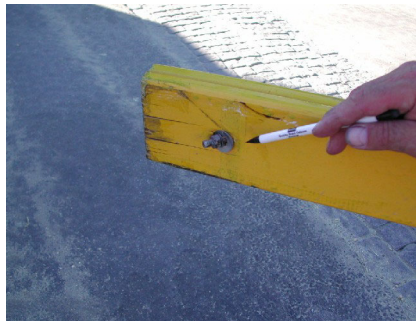
Skrapmärke på toppbräda samt deformerad bult på bom 3 från lastbilens högra sida.
