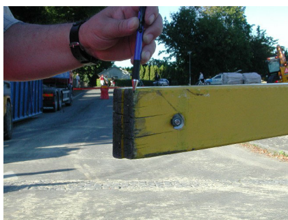
Skrapmärke på toppbräda samt deformerad bult på bom 3 från lastbilens högra sida.
