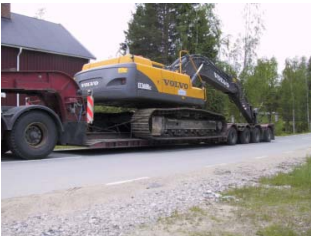
Trailern i transportläge, vilket innebär en markfrigång på 19 – 20 cm
