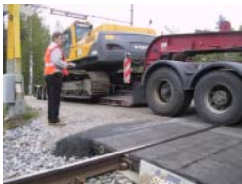
Vid återtransport över korsningen, med trailern i transportläge, fastnade den i gruset innan gummi-elementen i korsningen. Dragbilen blev stående på spåret.
