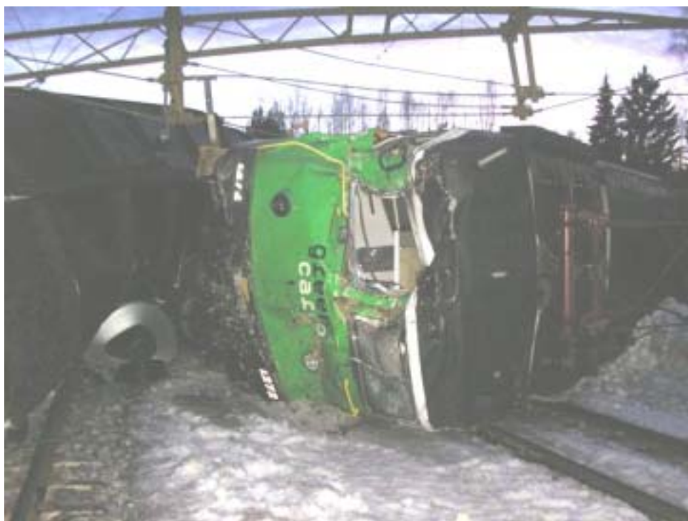
Lokets front, som kolliderade med trailern lastad med grävs kopan
