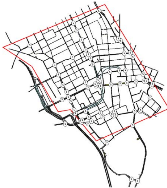
Figur 46: Nätverksmodell för City-området i Transmodeller och område för beräkning av VKT och VHT (röd gräns)
