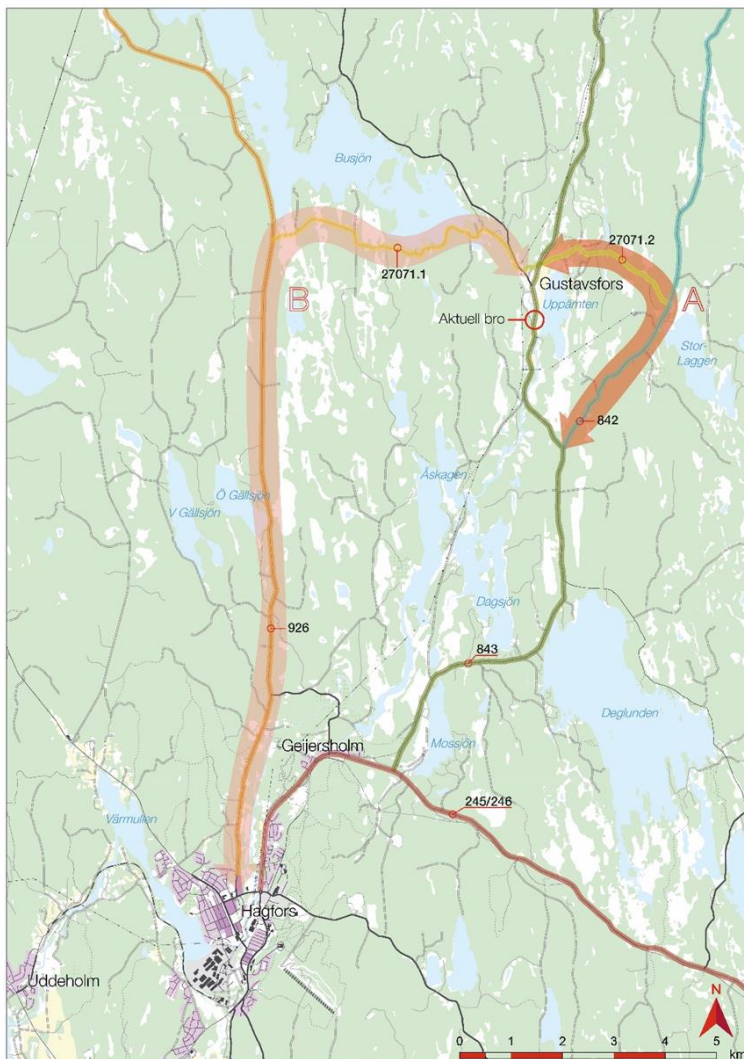
Bild 19 Identifierade omledningsvägar inkluderande enskilda vägar. Primärt avsedda för persontrafik till/från Gustavsfors -Hagfors. Tung trafik och primär omledning sker på statliga vägar via 842-519-843.
